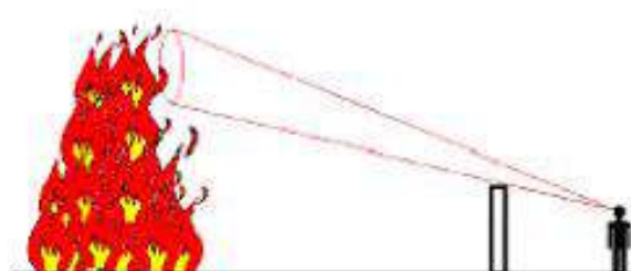
Figure 42 : Ecran lointain (ex : limite propriété) avec une bonne efficacité de l'écran
