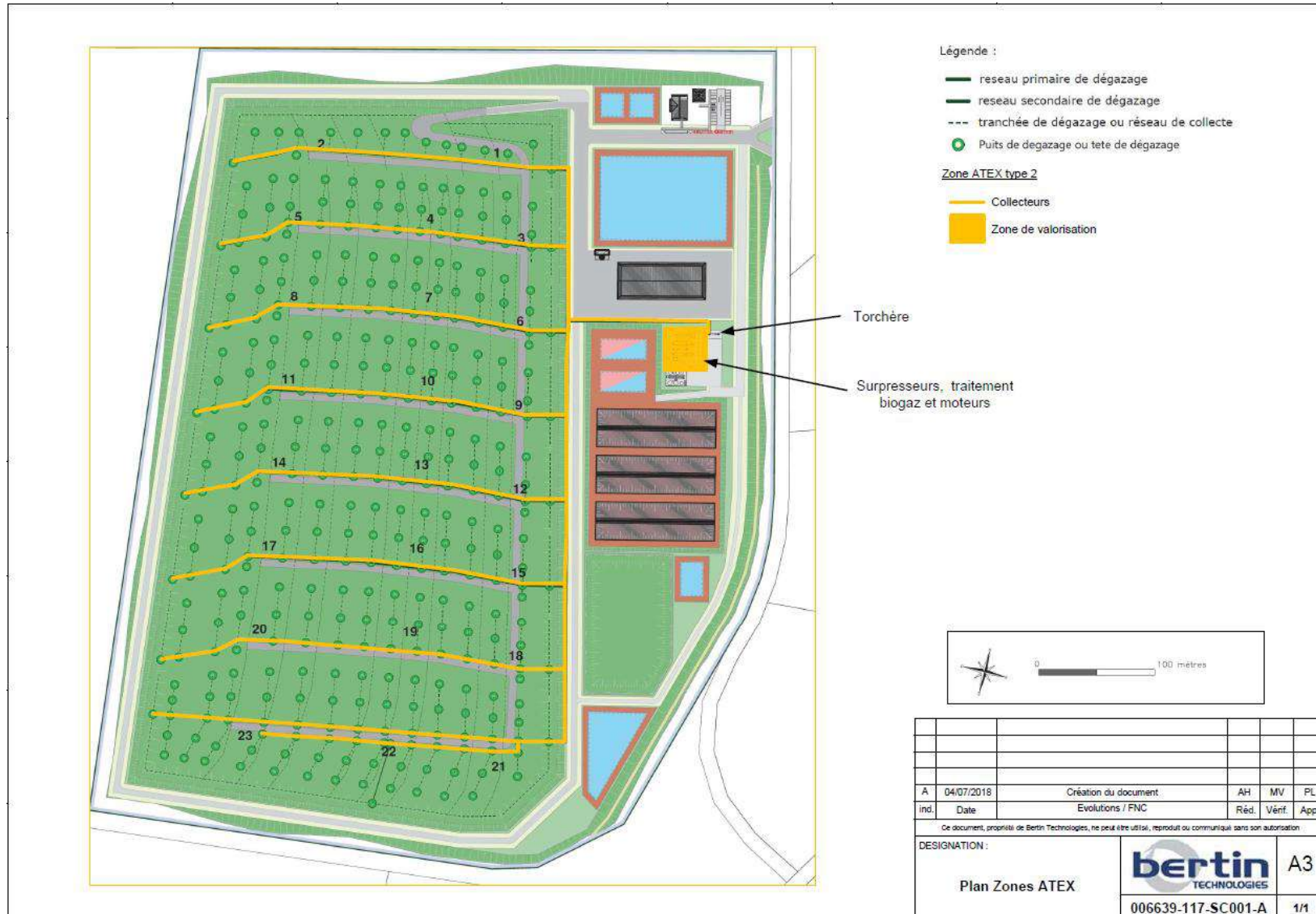
Figure 28 : Détermination du zonage ATEX du biogaz de l'ISDND (Source : Etude ATEX – Bertin Technologies)
