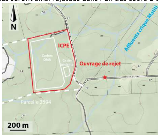
Figure 25 : Point de rejet des eaux traitées
