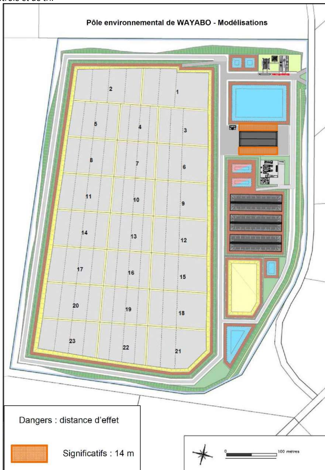
Figure 49 : Scenario 3 : Incendie du bâtiment tri - limites des flux thermiques (Source : Bertin Technologies)
